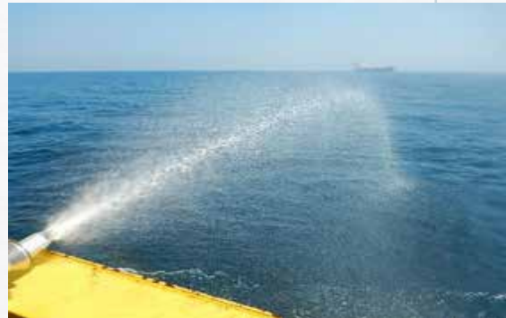
الشكل رقم 11: مسدس رش ذو فوهة واحدة (يسار) ينتج نفاث رش غير مستو (يمين)
