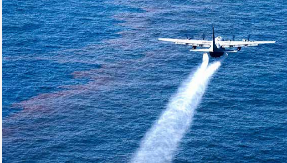
الشكل رقم 13: منظومة الرش بعد تثبيتها على طائرة
