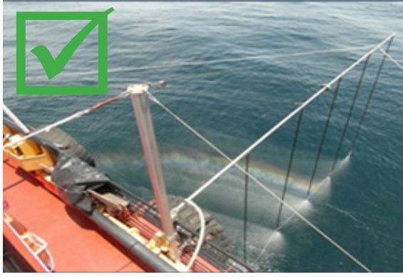
الشكل رقم 30: يتم الاستعانة بالأنايب السفلية على ذراع الرافعة للسماح بالرش على ارتفاع 1 إلى 1.5 متر فوق سطح الماء
