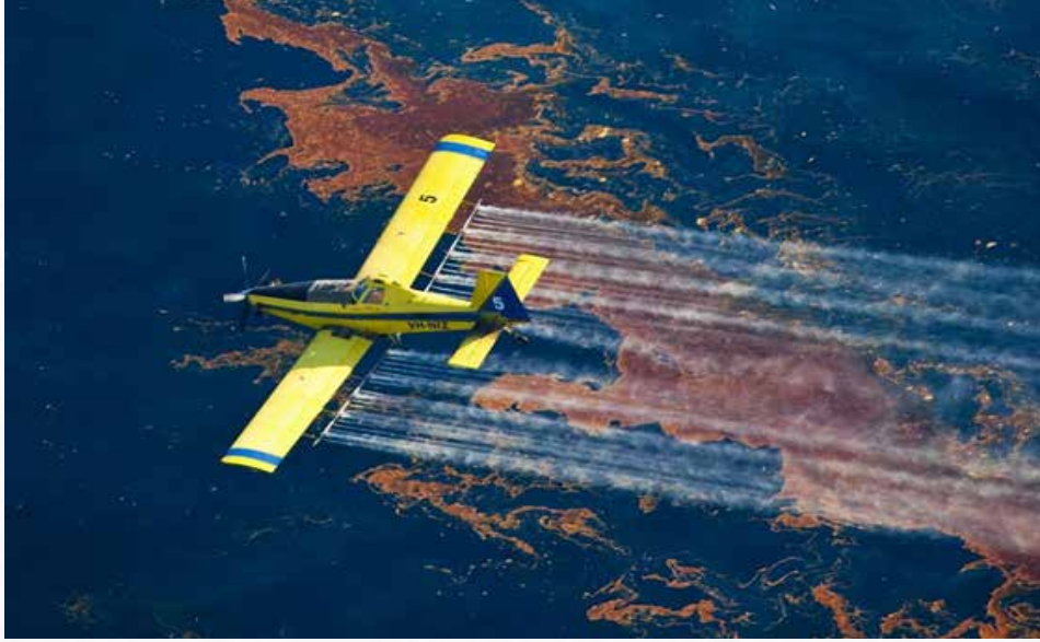
الشكل رقم 12: استخدام طائرة لرش المحاصيل في رش المشتتات فوق التلوث النفطي (Source: https://www.amsa.gov.au )
