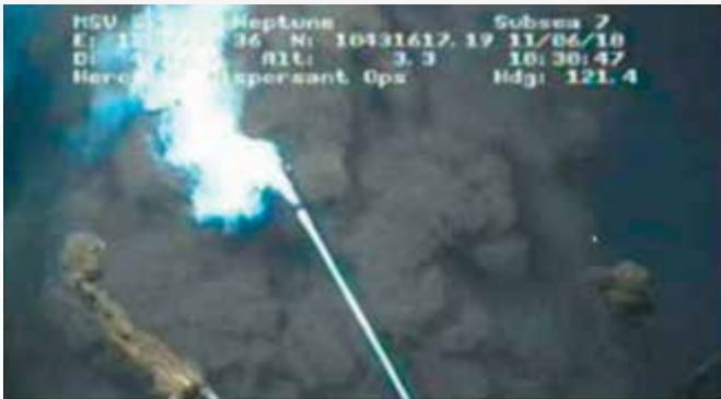
الشكل رقم 15: استخدام المشتتات تحت سطح البحر عند رأس البئر
