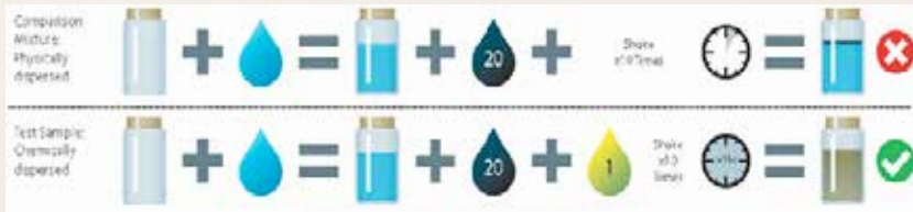
(الشكل 6) : عملية اختبار فعالية استخدام المشتت
