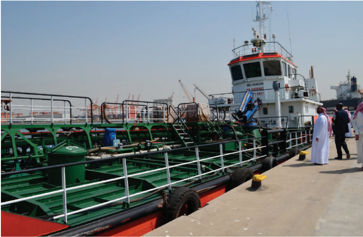
الشكل رقم (6) : سفينة مخصصة لمكافحة التلوث مجهزة بمعدات لفصل واستعادة الزيت مثبتة عليها (PERSGA, 2020)
