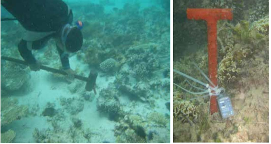
شكل 6.2. (a) وتد على شكل حرف T مصنوع من الحديد (ومثبت به مسبار لقياس درجة الحرارة)، (b) دق أوتاد في قاع الشعاب المرجانية باستخدام مطرقة ثقيلة.
