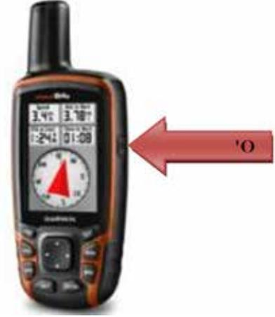
5. ستظهر الأقمار الصناعية التي عثر عليها الـ GPS لتحديد موقع برقم لونه أخضر في صفحة «القمر الصناعي». وبمجرد عثور الـ GPS على ثلاثة أقمار صناعية أو أكثر سوف يتم تحديد الموقع ، وكلما زادت عدد الأقمار الصناعية التي تعرّف عليها الـ GPS كلما زادت الدقة في تحديد الموقع.
