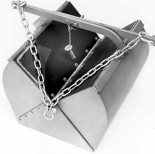
شكل 4.4. قالب تجميع الرواسب (Van Veen Grab)
