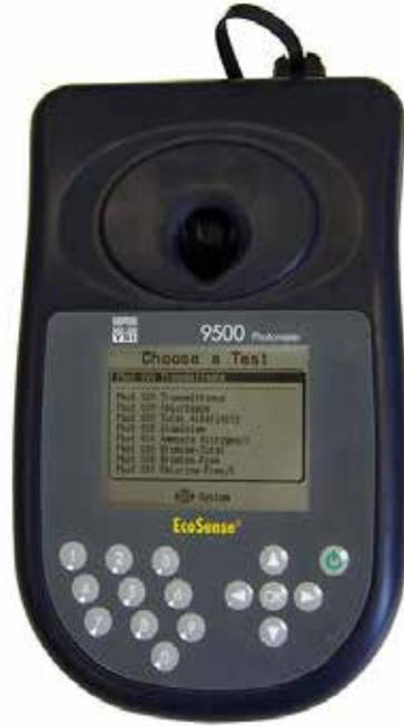
شكل 4.5. المقياس الضوئي (EcoSense 9300 & 9500 Photomete)
